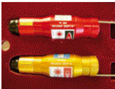
Fig. 2 : Pièces spéciales (585 et 650 nm) / MultiLite dye laser handpieces (585 & 650 nm) (Collection Hervé Van Landuyt)
